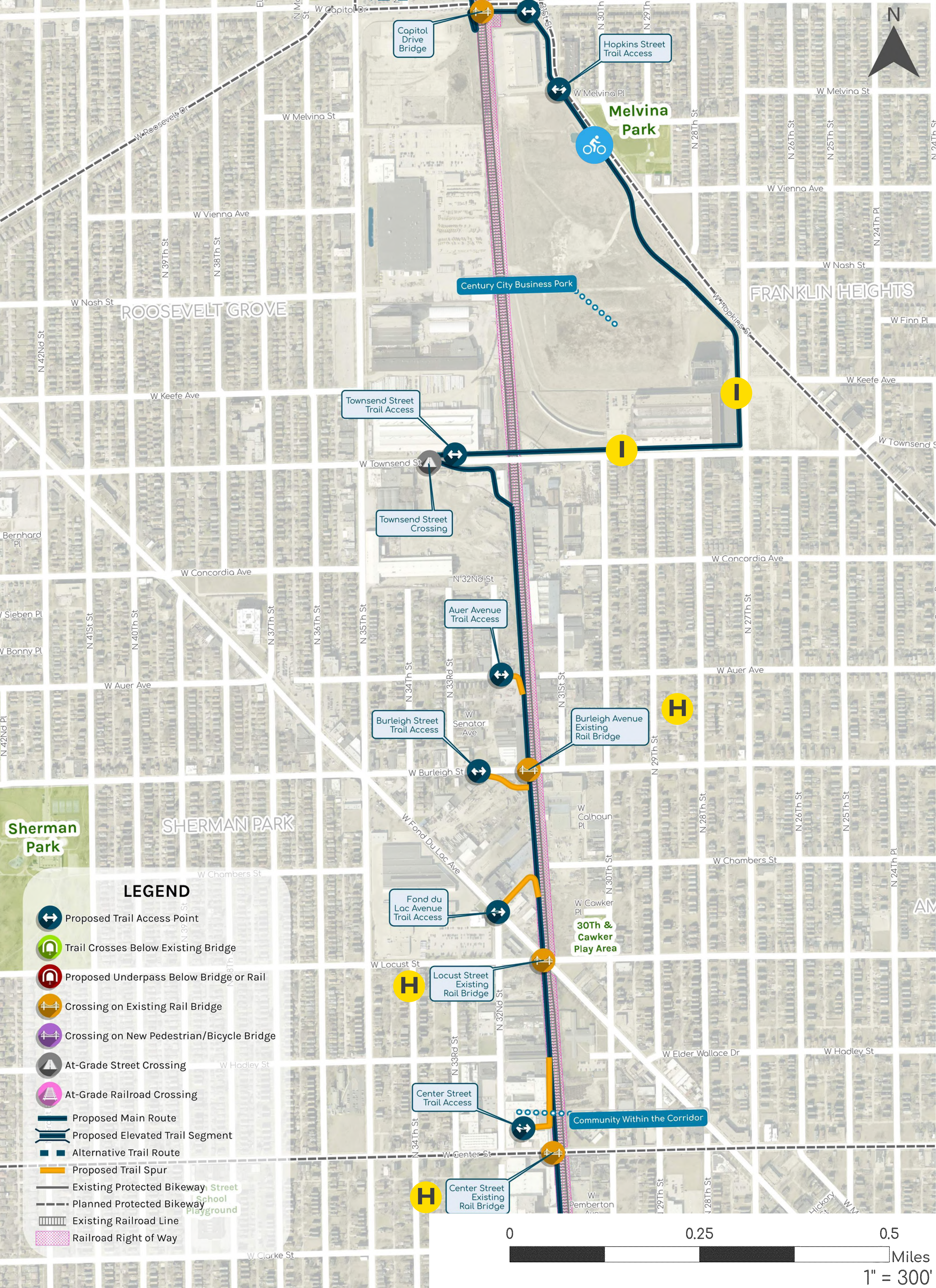
Proposed trail alignment, W. Center St to W. Townsend St, looking north Trazado propuesto del sendero, desde W. Center St hasta W. Townsend St, vista hacia el norte
